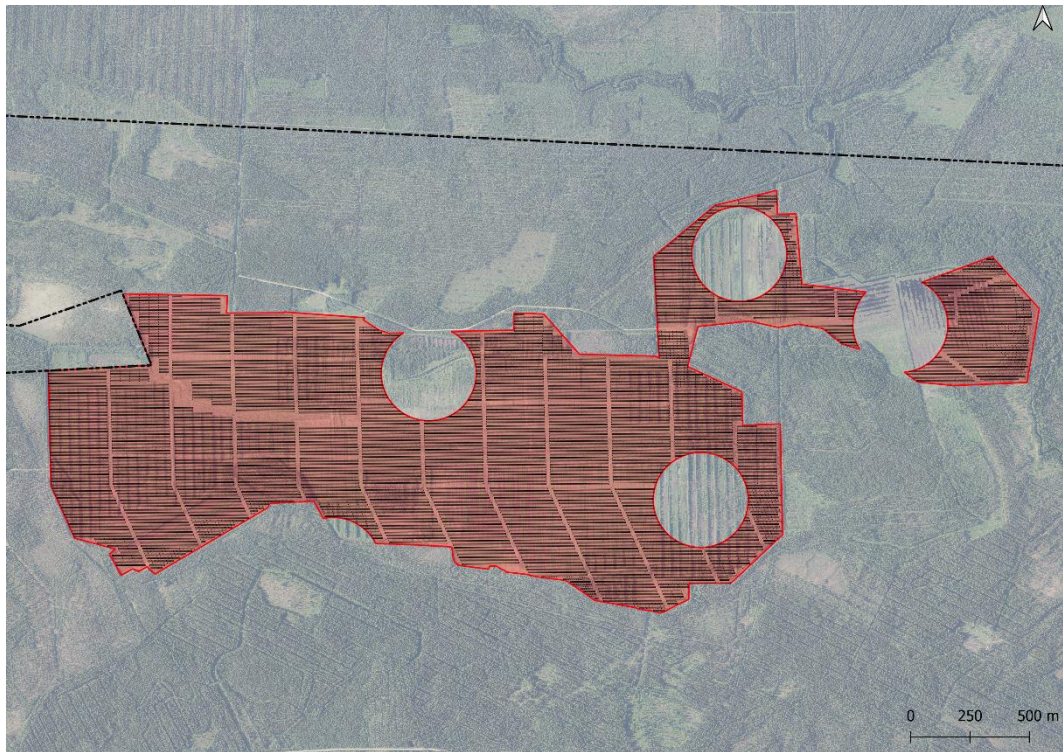
Kuva 10. Alustava luonnos vaihtoehdon VE1 mukaisesta aurinkopaneelien asettelusta Vainiosuon aurinkoenergiantuotantoalueelle. Aurinkopaneelien asettelu tulee tarkentumaan paneelien toimittajien vahvistuessa. (Ortokuva MML)
