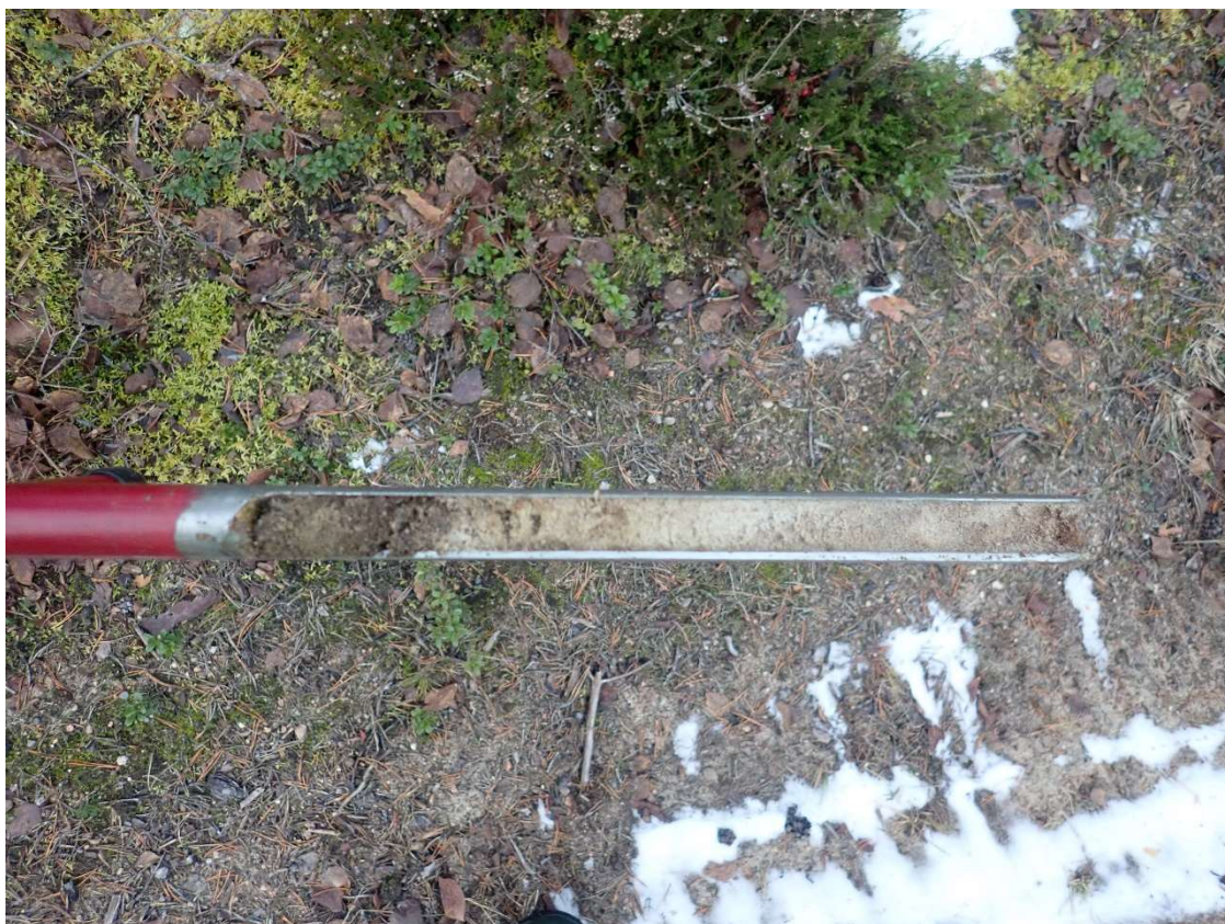
Kuva 19. Tiestä otettu kairaus, josta erottuu täyttökerros.
