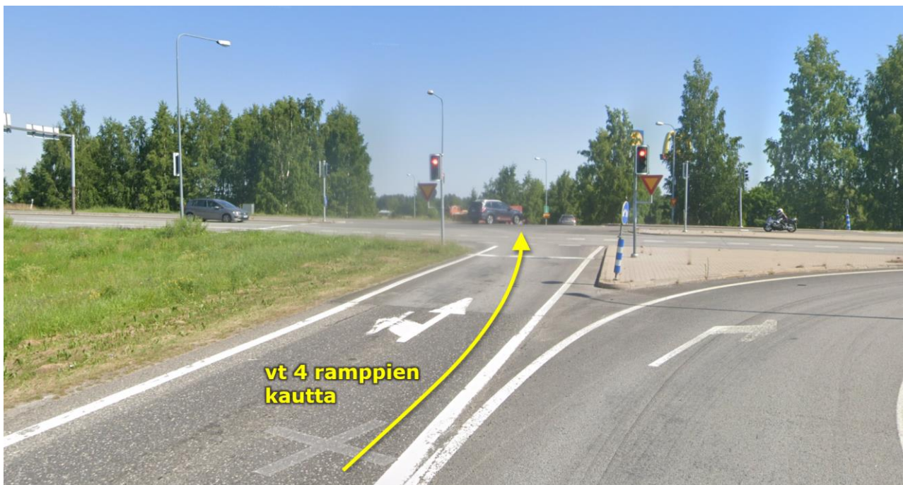
Kuva 5: Korkeat erikoiskuljetukset on liikennöitävä valtatie 4 ramppien kautta Kempeleellä sijaitsevassa eritasoliittymässä (POS A1), jossa on varmistettava tiegeometrian soveltuvuus lapakuljetuksille.
