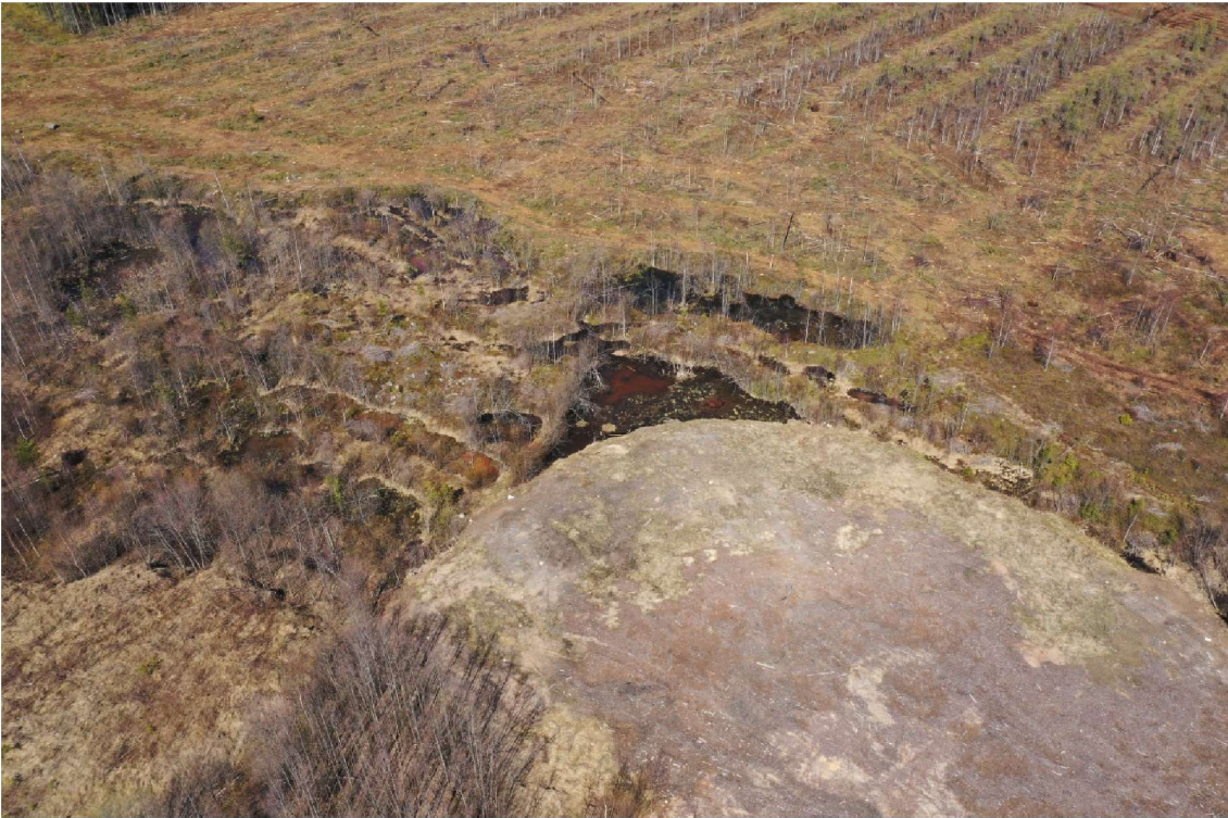
Kosteikon itäosan aluetta kuvattuna pohjoiseen 13.5.2020. Etualalla maankasausalue on työntynyt kosteikon reunalle siten, että maata on vyörynyt veteen. Maankasausalue on tasattu ja useita metrejä korkeammalla tasolla kuin vesialue.
