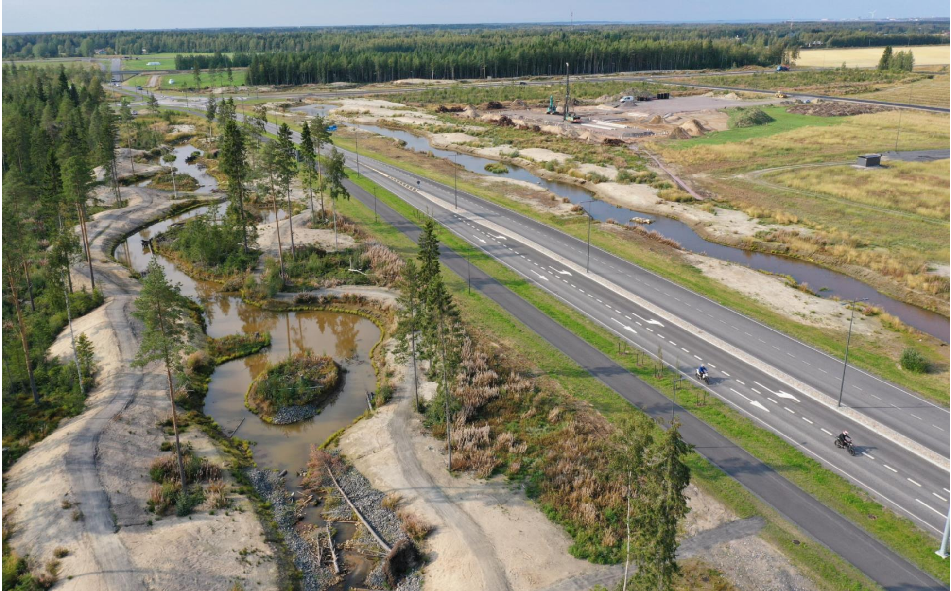
Komeetantie, kuvaussuunta länteen. Zatelliitinpuiston kosteikot toimivat myös hulevesien puhdistuksessa (nelostien kumipöly mikromuovina, asutusalueet), kuten myös maa- ja metsätalouden vesiensuojelussa (valuma-alue 250 ha). Kuva: Juha Siekinen
